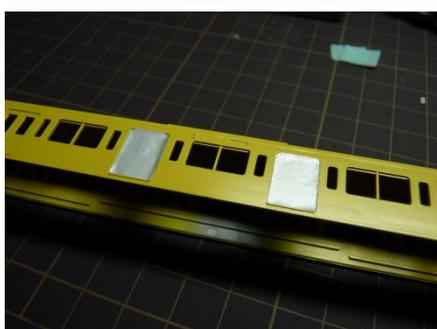
…閑話休題。素組みの済んだ車体は塗装されていつもの黄色の車体になりました。ここで現行品であればドア部分を残してマスキングテープで隠し、一度下地を吹いてから銀の塗料でドアを塗るわけですが、ここで今回のドアデカールを使用します。水転写式デカールという名が示す通りこのデカールの特徴は水を利用して車体へ転写することです。手元のカタログ(1992年版)によれば、切り取った後水の中へ入れ、ぬるま湯なら 10 秒、水なら 15~20 秒ほどでデカール部分だけが浮き上がってくるので、それを車体に載せる…とあります。今回もそれに従い、まずドア部分を 1 枚ずつ切り取り、これを水に入れ…たのですが、これがなかなか紙がはがれませんでした。経年劣化なのか、それとも水が冷たかったのか…(製作日は 11 月の中でも肌寒い日でした)。概ね 60 秒ほどでやっと紙から分離したので、これを車体に載せます。
