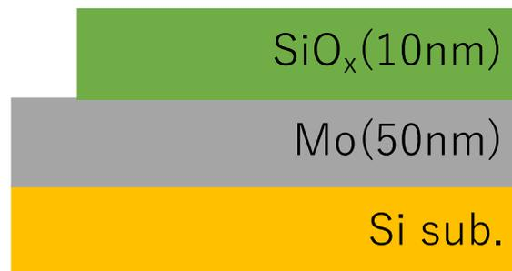
図 2-7  $\text{SiO}_x$  蒸着時点での断面構造
