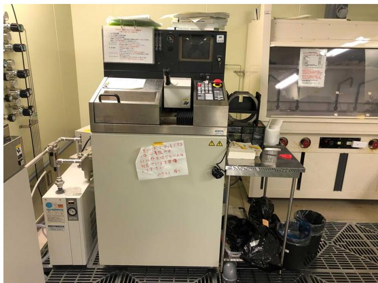
Fig. 2-1 ダイシング装置の外観写真
