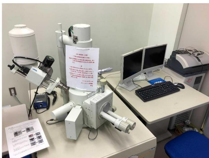
Fig. 2-21 エネルギー分散型 X 線分光装置の外観写真
