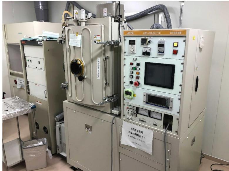
Fig. 2-8 電子ビーム蒸着装置の外観写真
