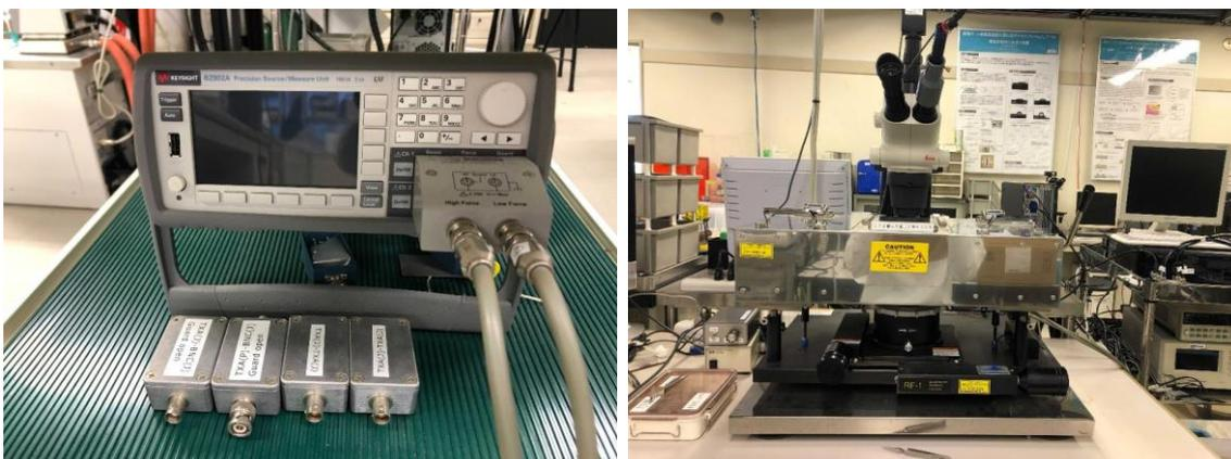
Fig. 2-25 半導体パラメータアナライザとプローバーの外観写真
