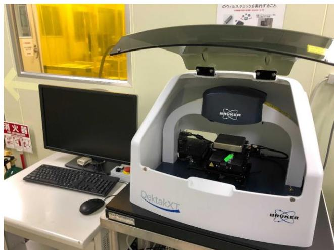
Fig. 2-13 触針式表面形状測定装置の外観写真
