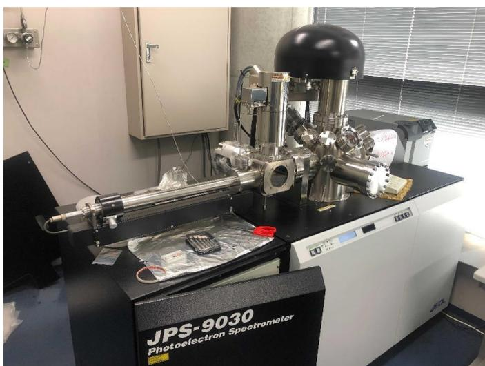
Fig. 2-19 X 線電子分光装置の外観写真
