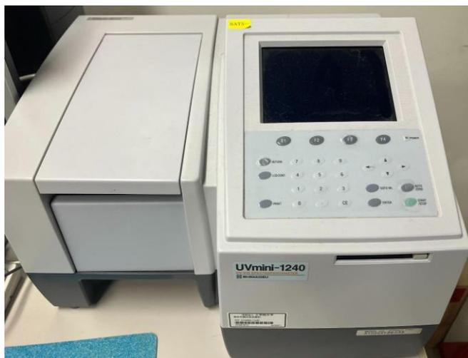
Fig. 2-15 紫外可視近赤外分光光度計の外観写真
