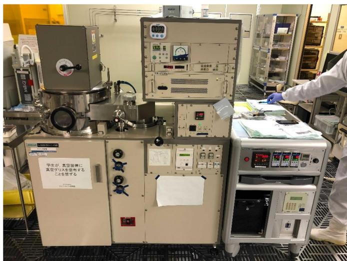
Fig. 2-7 スパッタ装置の外観写真
