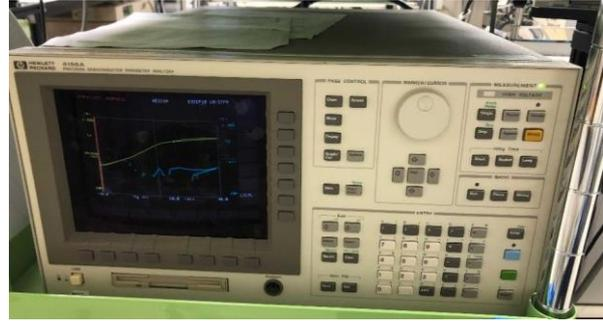
Fig. 2-31 真空プローバーと半導体パラメータアナライザの外観写真
