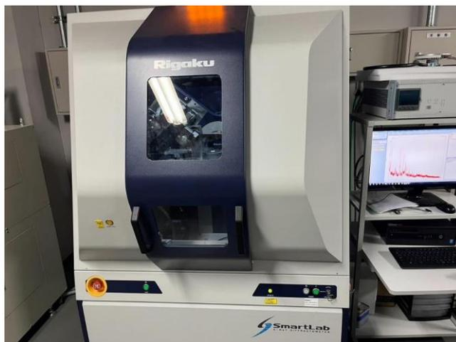
Fig. 2-17 X線回折装置の外観写真
