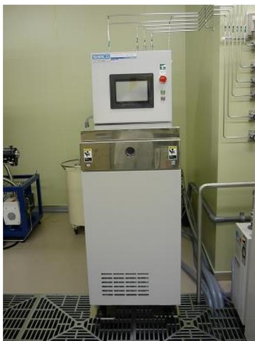
Fig. 2-2 反応性イオンエッチング装置の外観写真
