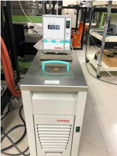
Fig. 2-33 循環恒温槽の外観写真
