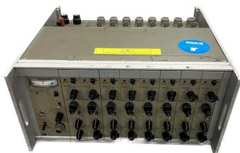
図 20 動ひずみアンプ (DPM-8H)
