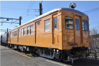
モニ 2005 は戦後期に活躍した 2000 系を改造した車両である。旅客営業終了後は荷物電車に改造されたが、その 2 年後に荷物扱いが廃止されて事業用車両となった。晩年はモニ 2019, 2023 とともに架線検測などに充当されていたが、700 系（モヤ 700：後述）の登場により引退した。現在はモニ 2005 のみが保存されている。
