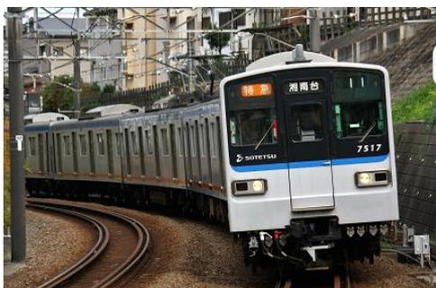
新 7000 系は 1986 年から 1989 年にかけて投入された編成（第 12 次増備車以降）で、前面のスタイルが大幅に変更されたため、在来の 7000 系に対する視覚的な区別から新 7000 系と呼ばれる。1970 年代後半より流行した前面窓周りに黒色を配色し前面窓を大きく見せる手法（ブラックフェイス）が相鉄の車両としては初めて導入されている。車内設備では、天井構造が平天井に変更されたほか、一部の車両にセミクロスシートが試験的に導入されて乗客に好評だったため、後発の 8000 系などで採用された。
