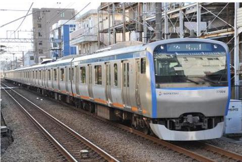
11000 系は 2009 年に営業運転を開始した通勤型電車で、JR 東日本の E233 系をベースとしている。現在は 10 両編成が 5 編成在籍している。東急車輛製は屋根上のビード形状が細いタイプ、新津製はビード形状が太いタイプと異なっている。老朽化が進んでいる 5000 系および 7000 系初期車の置き換えを目的として製造された。10000 系や 11000 系のような新系列車両は耐久性や耐摩耗性に優れており、新保全体系という従来の検査体系を簡略化した（機器ごとに検査周期を適正化した）検査体系をとっている。
