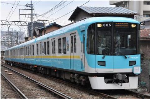
800系は京津三条～御陵間廃止による京都市営地下鉄東西線への乗り入れ開始に合わせて1997年に登場した車両です。4両×8編成が導入され、全編成が京津線と京都市営地下鉄東西線で運行されています。車両には地下鉄区間や京津線の急勾配と急カーブ、そして併用軌道を直通するための様々な工夫がなされています。地下鉄と併用軌道における架線の高さの違いに対応可能なシングルアームパンタグラフが搭載されているほか、61%の急勾配を走行
