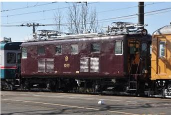
ED10 形は 1952 年に登場した電気機関車で、デッキの付いた前面が特徴だ。主に砂利やセメントの輸送、そして厚木基地への燃料輸送に使用されたが、貨物輸送廃止による運用の減少や老朽化を受けて 2007 年に廃車となった。ED11～14 の計 4 両のうち、現在は ED11 のみが保存されている。
