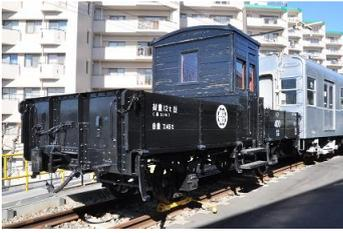
トフ 400 形は相鉄の前身である神中鉄道が 1928 年に導入した貨車で、中央に車掌室がある凸型の配置が特徴である。トフ 400～404 の計 5 両が製造されたが 1994 年までに全車引退し、トフ 400 のみが保存されている。
