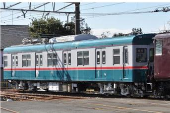
旧 6000 系は 1961 年に登場した車両で、モハ 6001 はそのトップナンバーである。相鉄初の 20m 両開き 4 扉車で、前述のモハ 6021 以外は普通鋼製となっている。実用的な通勤型電車として相鉄の発展に深く寄与した車両であり、35 年以上もの期間運用された。なお、1970 年以降に増備された編成は車体や機器類が大きく異なっており、新 6000 系と呼ばれている。
