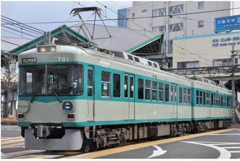
700形は1992年に登場した車両で、350形と500形の車体を流用して2両×5編成が製造されました。スペックは600形を基本としながらも6000系から7000系への流れを汲み前面が直線的なデザインに変更されたほか、当初から1500V昇圧を見越した設計となっていました。
