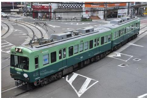
600形は1984年に登場した車両で、300型および260形の車体を流用して2両×10編成が製造されました。同時期に製造された6000系に類似して半流線型となっている前面が特徴です。300型を流用した1次車（4編成）と260形を流用した2～4次車（6編成）では前面窓のデザインが異なり、前者は平面ガラスなのに対し、後者はパノラミックウィンドウとなっています。また、1次車の連結面
