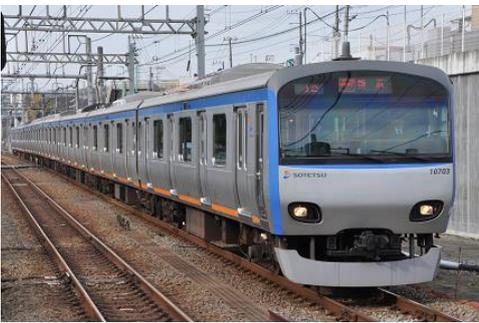
10000 系は 2002 年から営業運転を開始した通勤型電車で、JR 東日本の E231 系をベースとしている。現在は 8 両編成が 5 編成、10 両編成が 3 編成在籍している。車体限界幅が JR 東日本より 50mm 狭い 2950mm のため、E231 系より車体幅を 20mm 縮めた 2930mm である。相鉄の特徴であったパワーウィンドウの採用は見送り、すべて手動での開閉となっている。2008 年頃からは車内自動アナウンスを導入し、注目を集めた。このように、10000 系は相鉄の歴史に新たなページを作った車両である。
