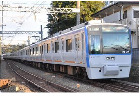
9000 系は 1993 年から導入された通勤型電車である。車両自体は 8000 系に似ているが、異なる点が多い。特にデザイン関連から異なる点が多く、前面の連結器はカバーで覆われ、空調では分散式を採用し車体屋根にある 4 つの空調設備を縦に長く覆うようにカバーを設置した点が挙げられる。最近では濃紺一色（ヨコハマネイビーブルー）で塗装され、一部の座席をスコットランド製の本革を使用した車両も登場している。
