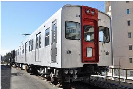
モハ 6021 は旧 6000 系のアルミ合金車体試作車として 1967 年に 1 両のみが製造された。普通鋼製のモハ 6000 に比べて約 4.5t の軽量化に成功し、その後の車体製造に大きな影響を与えた。また、前面の貫通扉周辺は赤色で塗装され、この赤色系塗装は 9000 系(旧塗装)まで引き継がれることになった。
