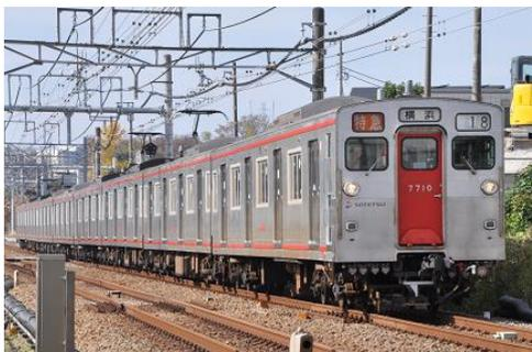
7000 系は 1975 年から導入された通勤型電車である。全車両が新製当初より冷房装置を搭載している。ロール材などを活用し、軽量化を図った車両構造である。座席は全てロングシートで、生地の色は当時の相鉄の標準であったオレンジ色を採用した。3 次車以降はモハ 7100 形の連結面に、風を遮るための貫通扉が設置されている。本系列は前述のように製造当初から冷房装置を搭載していたが、天井に扇風機を併設している。現在、本形式は相鉄で最古の車両系列となっており、8 両編成が活躍している。
