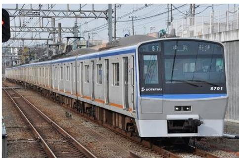
8000 系は 1990 年から導入された通勤型電車である。特徴として車両製造のコンセプトが「21 世紀でも通用する車両」である。そのため、先代の 7000 系とは異なり、前面の貫通扉が中央から左に変更になったほか、それまでの車両では急行・各停などの列車種別のみで行き先表示がされなかったが、本形式から両方が表示されるようになった。初期の車両の色は白と赤のラインであったが、その後は白い車体に青とオレンジのラインに変更された。
