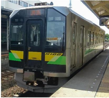
使用車両は左にある JR 北海道期待の新星 H100 形気動車。これまで乗ってきたキハ 54 形やキハ 40 形の置き換え車両として登場した車両である。この車両の最大の特徴は何といても JR 北海道初の電気式気動車であることだ。気動車には液体式気動車と電気式気動車が存在し、キハ 54 形やキハ 40 形は液体式に該当する。ここで気動車の話を始めると全く収まりがつかなくなるために割愛するが、分かりやすく言うと液体式はエンジンからの駆動力を液体を用いた変速機を介し推進軸に伝え、車輪を動かす。一方、電気式は気動車のエンジンを使って発電機
