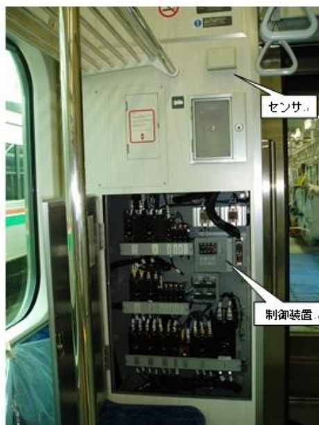
図 7: JR E721系車壁に設置されたセンサと内部に格納された制御装置 [松澤氏提供]
