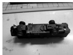
図 1。前進方向にマグネットが装着されているのがわかる。
