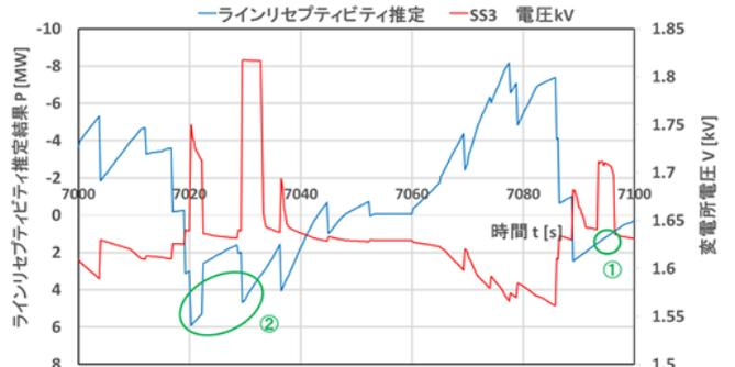
図2 ラインリセプティビティ推定と変電所電圧との比較
