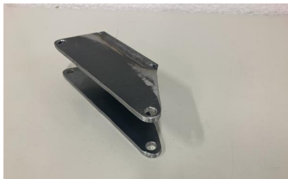
Fig.8 製作したリアアップライトブラケット
