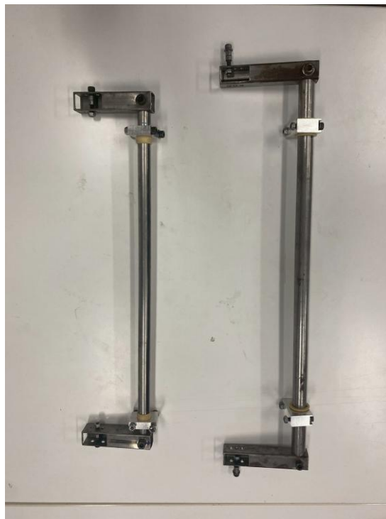
Fig.3 製作したスタビライザー
