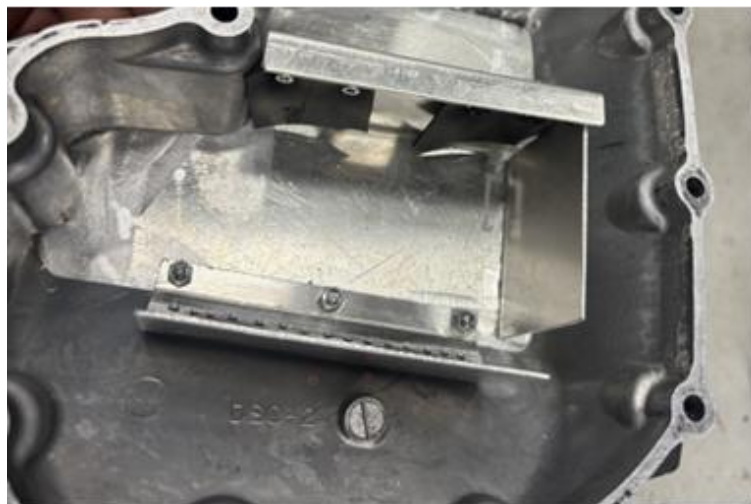
Fig.1 オイルパン内のバッフルプレート
