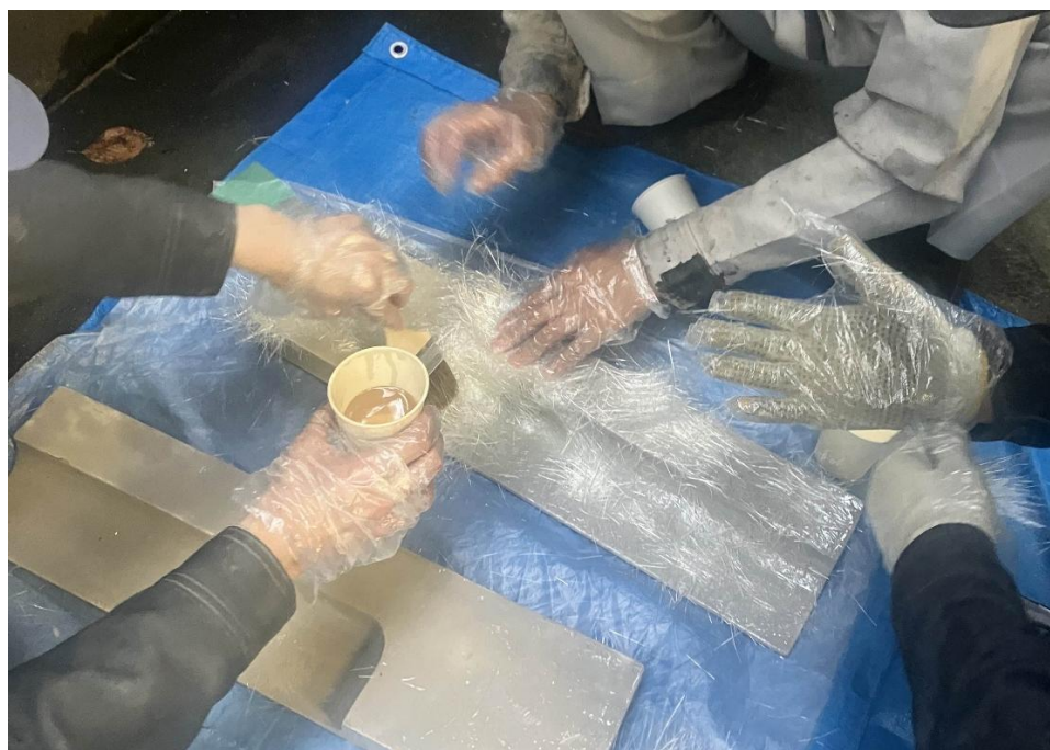
Fig.6 グラスウールの雌型製作の様子
