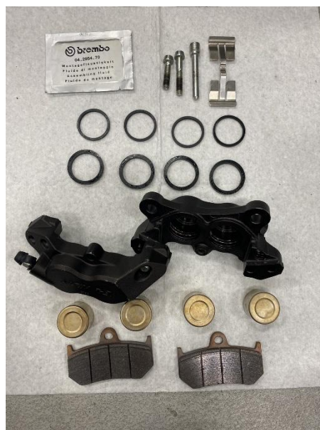
Fig.4 オーバーホール中のブレーキキャリパー
