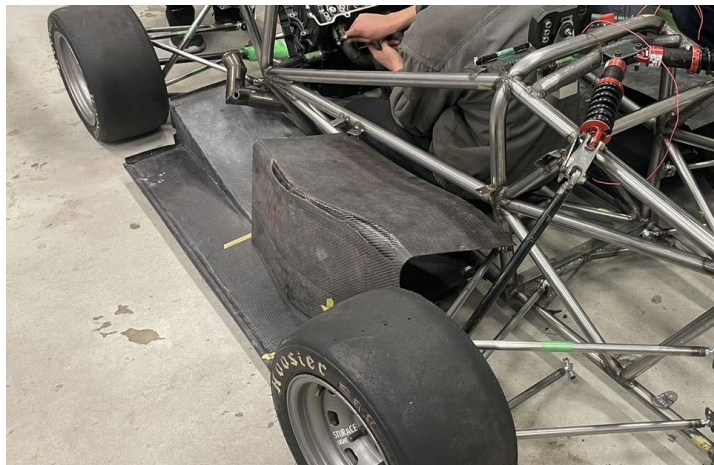
Fig.11 アンダーパネル、サイドポンツーン
