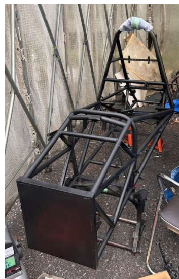
Fig.5 塗装後のフレーム
