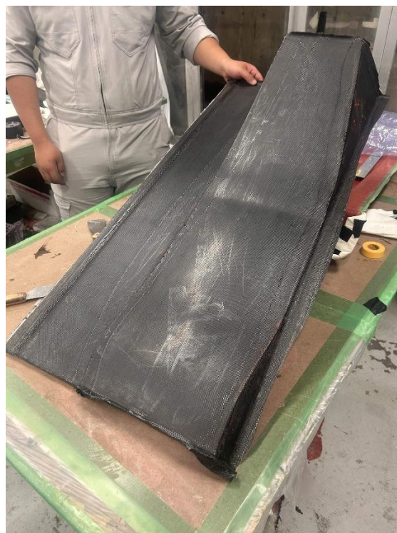
Fig.10 修繕したアンダーパネル
