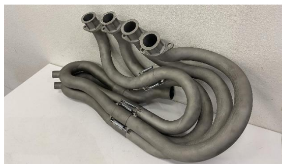
Fig.1 ご支援いただいた冷却ラインとエキゾーストマニホールド
