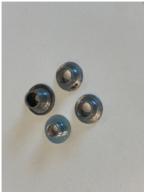
Fig.4 再製作したフローターピン
