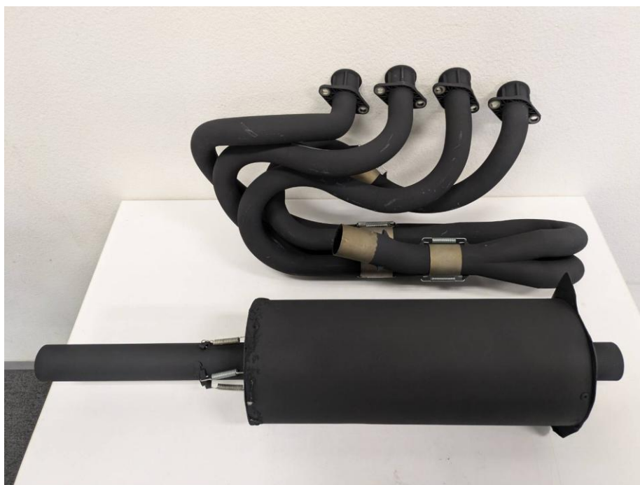
Fig.1 断熱塗装していただいたエキゾーストマニホールド
