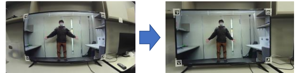
図 10 歪み補正を行った結果 (左：補正前 右：補正後)
