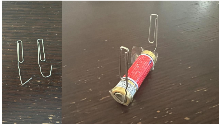
図16 クリップの加工と電池へのとりつけ
